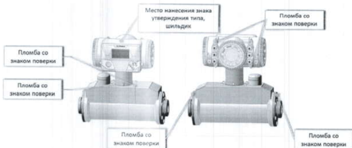
Рисунок 6 – Схема пломбировки комплекса исполнения ВА с муфтовым присоединением (модернизированный ИВБ), указание места нанесения знака утверждения типа, расположение шильдика
