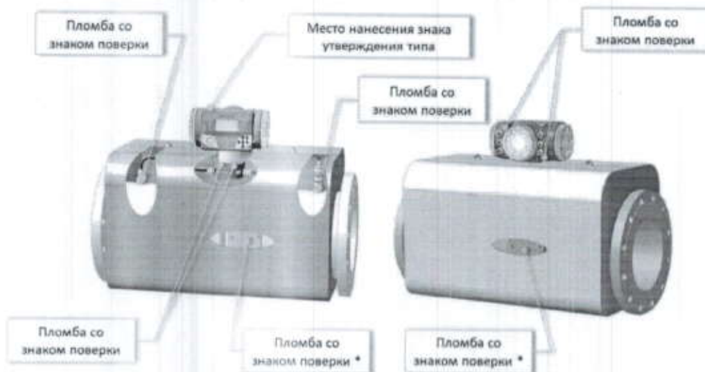
Рисунок 9 – Схема пломбировки комплекса исполнения ВТ, МТ с защитным кожухом указание места нанесения знака утверждения типа, расположение шильдика
