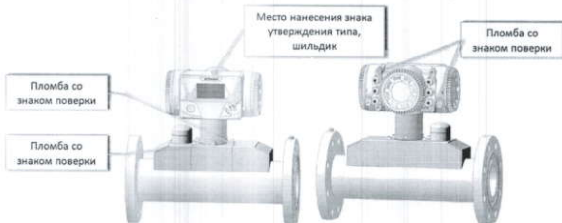
Рисунок 5 – Схема пломбировки комплекса исполнения ВА с фланцевым присоединением (модернизированный ИВБ), указание места нанесения знака утверждения типа, расположение шильдика
