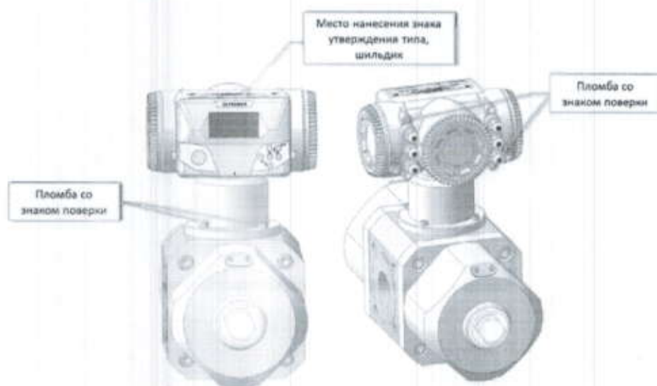
Рисунок 8 – Схема пломбировки комплекса исполнения RT, указание места нанесения знака утверждения типа, расположение шильдика
